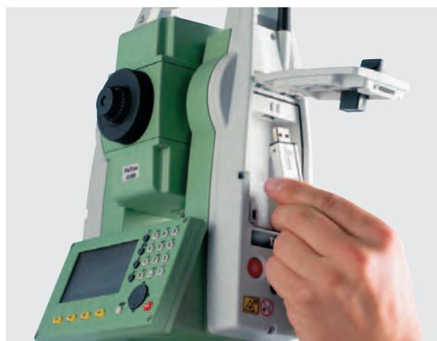
コミュニケーションサイドカバーによって煩わしいケーブル通信から解放され、Bluetooth® を介したデータ転送が可能です。例えば Leica Viva CS10 や CS15 との通信。USB メモリがあれば、GSI, DXF, ASCII, LandXML, CSV といったデータの受け渡しに柔軟に対応できます。
